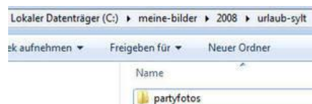
Abbildung 10 - Die Pfadangabe gibt an, wie ein Ordner oder Datei zu erreichen ist
